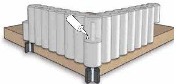
Positionering van het kettingelement met behulp van verlengde montagebuizen op losse ondergrond. Lijmen van de elementen is noodzakelijk
