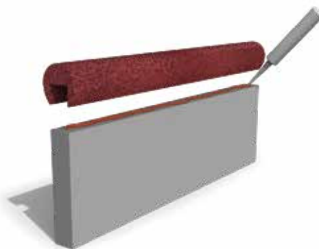
Selectieve verlijming van de rubbergranulaatcoating op de opstand.
